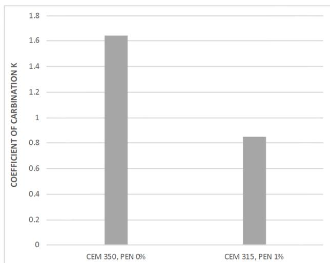
I risultati, mostrati nel grafico, evidenziano che additivando con PENETRON® ADMIX all'1% un calcestruzzo povero di cemento e con un più elevato rapporto a/c, si ottiene un **incremento della resistenza alla carbonatazione** (espressa mediante il coefficiente K) di quasi il 50%.
